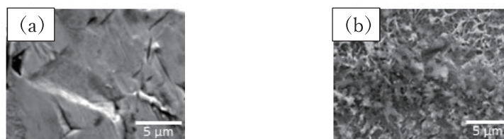
Fig.1 SEMで得られた表面画像 (a)純チタン窒素ドーピング未処理 (b)300°C-3h窒素ドーピング処理
