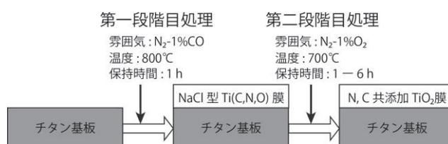
Fig. 1 二段階熱酸化法による炭素・窒素共添加 TiO<sub>2</sub> 膜作製プロセスの模式図
